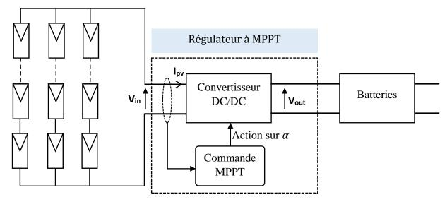
Les grandeurs fournies par les panneaux solaires sont variables en fonction de la température et du rayonnement solaire, ce qui rendre le rendement très faible ainsi le risque de diminuer la durée de vie des batteries (changements brutaux des grandeurs). La solution est la poursuite du point de la puissance maximale des panneaux solaire en augmentant au maximum la tension U sans faire baisser l'intensité I.
