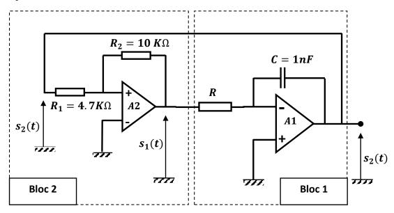
Commençons par étudier le montage du bloc1 : entrée s1(t) et sortie s2(t). Le fonctionnement de cet amplificateur opérationnel **A1** est linéaire.
