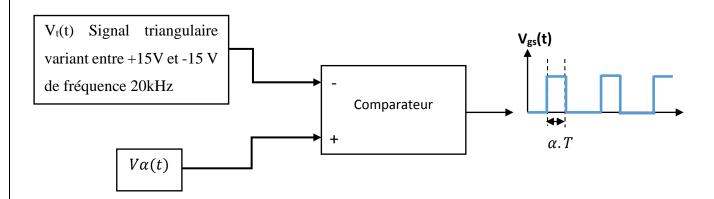
Le comparateur (dont la réalisation technologique ne sera pas étudiée) fonctionne de la manière suivante : la tension de sortie Vgs(t) vaut Vcc lorsque  $V\alpha(t) > Vt(t)$  et vaut 0 V dans le cas contraire.
